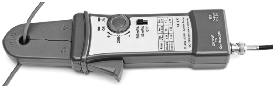
圖 2:連接到 PA-677 電流測試鉗
